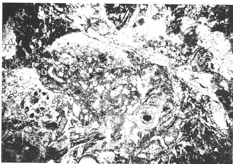
Obr. 2. Eocénny vápence od Podlužian s oolitmi. Zväč. 22 \times . Foto K a n t o r.
